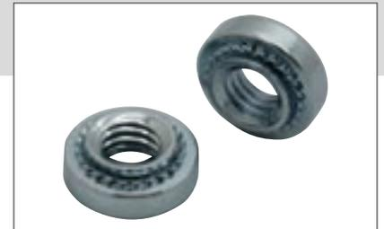
Einpressmuttern aus gehärtetem Stahl, geeignet für die Verarbeitung in Blechen mit Härten bis HRB 80.
