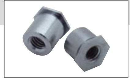
Einpressgewindebuchsen aus nicht rostendem Stahl (AISI 400er Serie), geeignet für die Verarbeitung in Blechen mit Härten über HRB 80 (bis 88).
