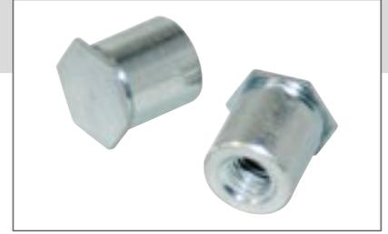
Einpressgewindebuchsen aus nicht rostendem Stahl (AISI 300er Serie), geeignet für die Verarbeitung in Blechen mit Härten **bis HRB 70**.
